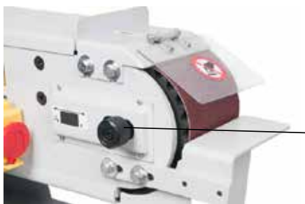
регулирующий винт для центрирования ленты на шкиве
